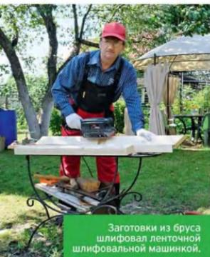
Заготовки из бруса шлифовал ленточной шлифовальной машинкой.
