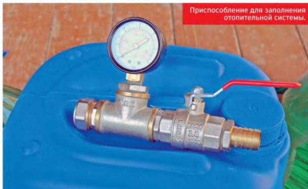
Приспособление для заполнения отопительной системы.
