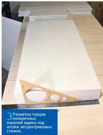
3 Разметка торцов поперечных панелей ящика под шток эксцентриковых стяжек.
