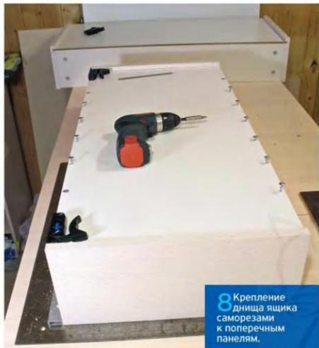
**8** Крепление дна ящика саморезами к поперечным панелям.
