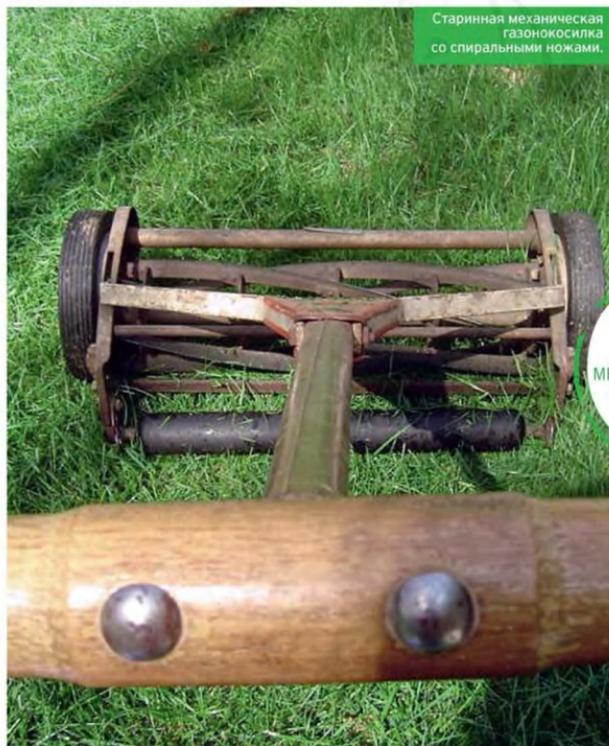
Старинная механическая газонокосилка со спиральными ножами.
